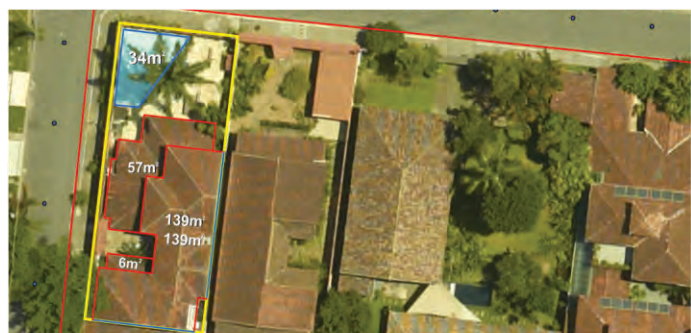
Medição da área construída
